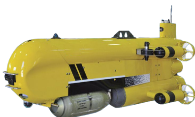
Exail PAP MK6 ROV : « Poisson Autopropulsé » latest generation of "Self-propelled fish"
